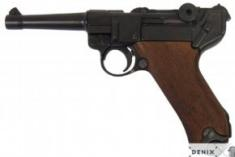
La pistola Parabellum o modelo 1908 (P08), popularmente conocida como Luger, es una pistola semiautomática accionada por retroceso, que sobrevivió a las restricciones del Tratado de Versalles. Utiliza una corredera interna, operada mediante un brazo articulado, al contrario de la corredera externa común en casi todas las demás pistolas semiautomáticas.
